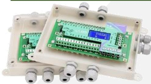
Boîte de jonction intelligente avec afficheur LCD rétro-éclairé, 38x16 mm, à deux lignes avec 8 chiffres de 5 mm. Quatre touches pour l'étalonnage. Dispositif de protection contre foudre et chocs électriques.
